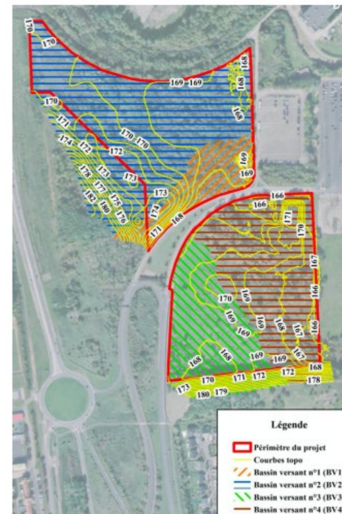
Figure 96 : Rappel de la localisation des 4 bassins versants initiaux identifiés par le bureau d'études SONDE&EAU / COMIREM SCOP
